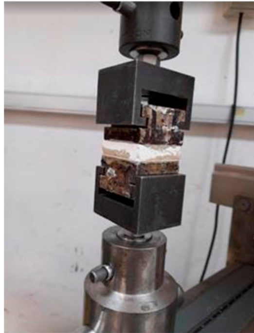
Fig. 1. Flatwise tensión test setup
